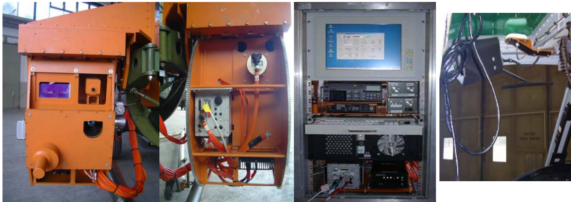
Slika 4: Izgled jednog od multi senzora (koji se montira na helikopter) za sinhronizaciju i obradu geoprostornih podataka (FGAN-FOM Research Institute for Optronics and Pattern Recognition, Ettlingen, Germany)
