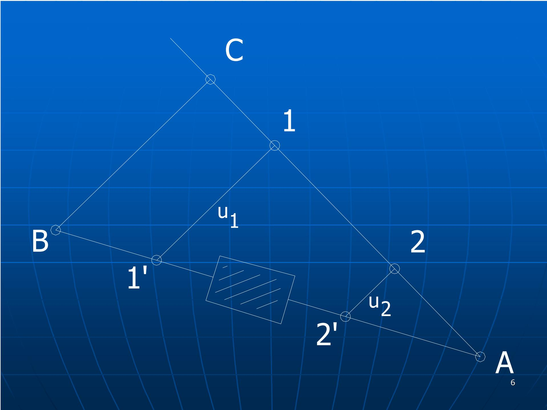
Postavljanjem pomoćnog trougla, iz tačke B se spusti upravna (tačka C). Izmeri se rastojanje A-C. Na pogodnim mestima se postave tačke 1, 2, ...
