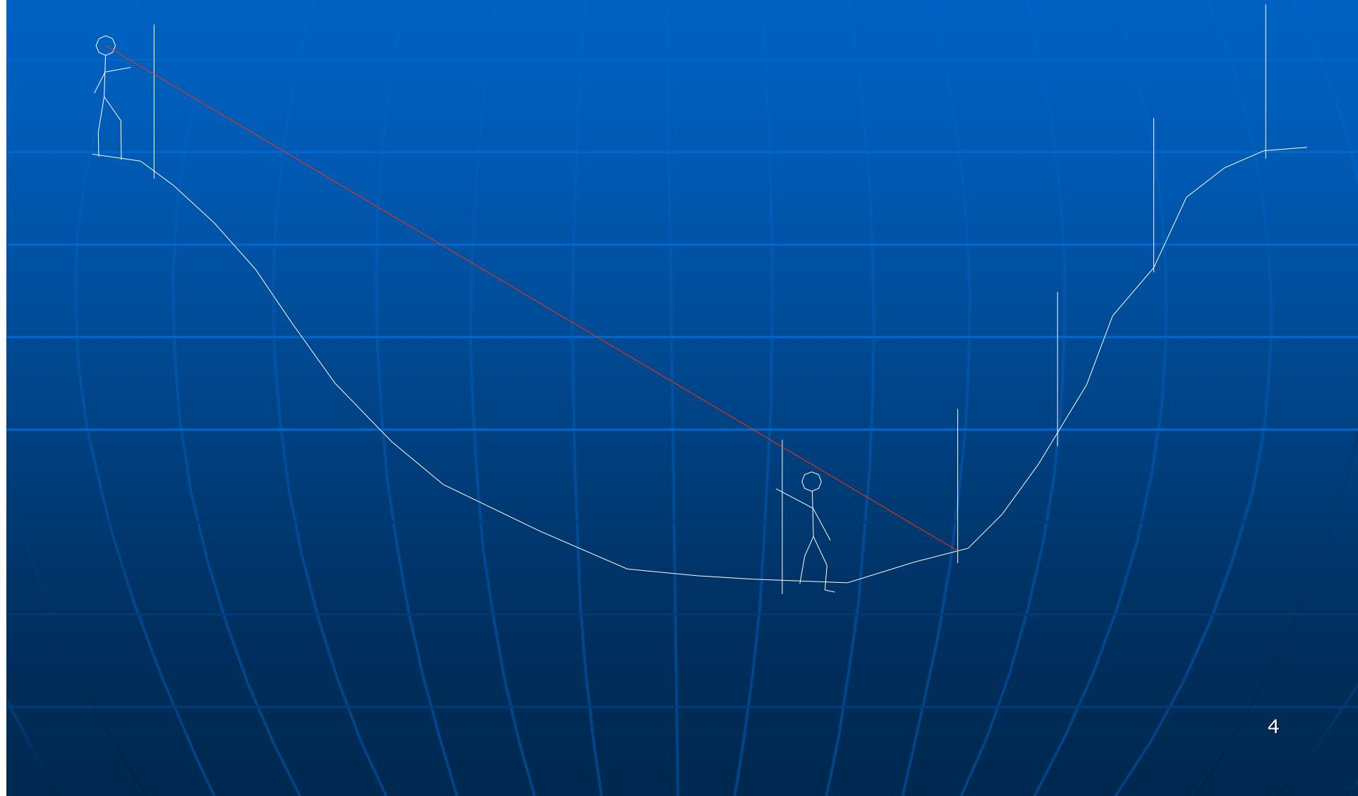
Postavljanjem pomoćnog trougla, izmere se dužine  $b$  i  $c$  i ugao  $\alpha$ , uglovi  $\beta$  i  $\gamma$  se sračunaju (tangensna teorema)
