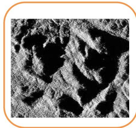
slika 16 – zasenčene oblasti na radarskoj slici koje ne nose nikakve informacije
