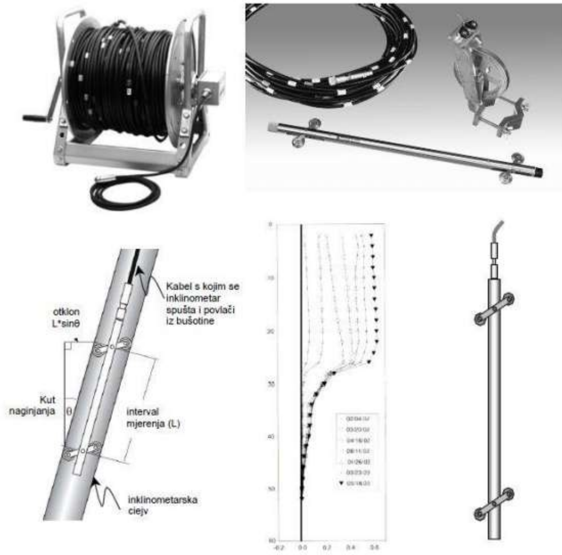
Слика бр.2 Делови инклинометра
