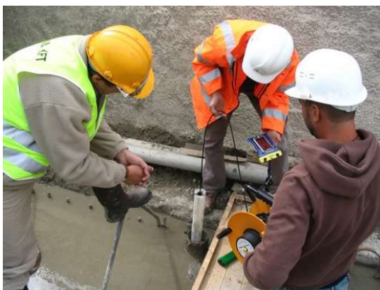
Слика бр. 14 Постављање инклинометарске сонде
