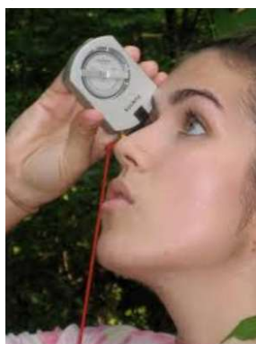
Слика бр. 12 Одређивање висине употребом скале гравирание на објектном сочиву
