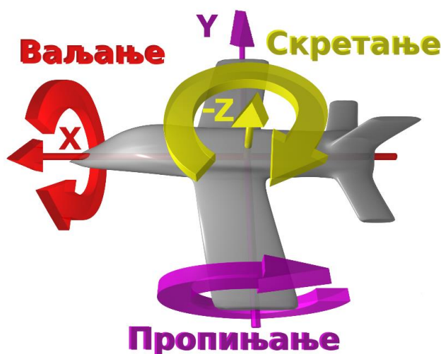
Sl. Kod inercijalnog navigacionog sistema, senzori registruju signale od translacije duž sve tri ose i od rotacije, oko njih.
