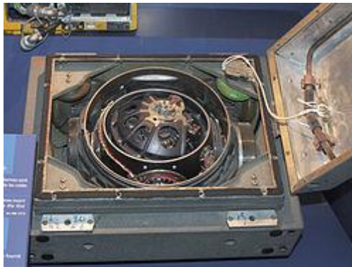
SLi. Francuski inercijalni navigacioni sistem, za balističku raketu srednjeg dometa S3.
