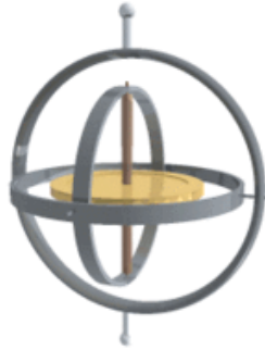
Sl. Kardanski mehanizam, sa tri slobodna prstena.
