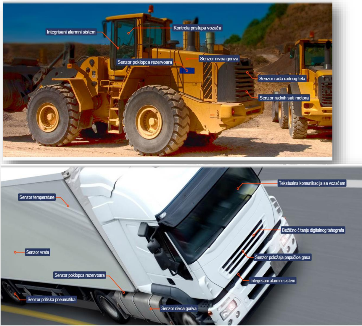
Slika broj 3: Ugrađeni senzori u vozila i njihova lokacija
