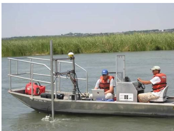
Slika 8. Čamac za snimanje opremljen ehosonderom i GPS uređajem
