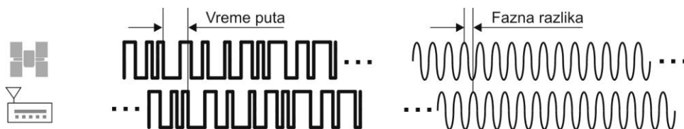
Slika 4.3. Princip merenja GPS prijmnika upoređenjem kopije i originala signala.
